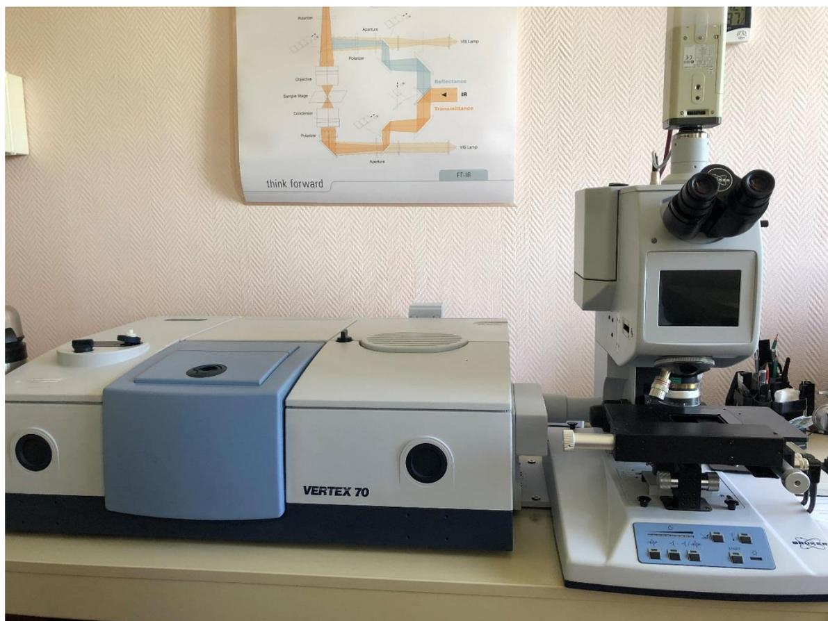
Рис. 2.2. Внешний вид ИК-Фурье спектрометра VERTEX 70 (Bruker) в комплексе с ИК-микроскопом Hyperion 2000.
