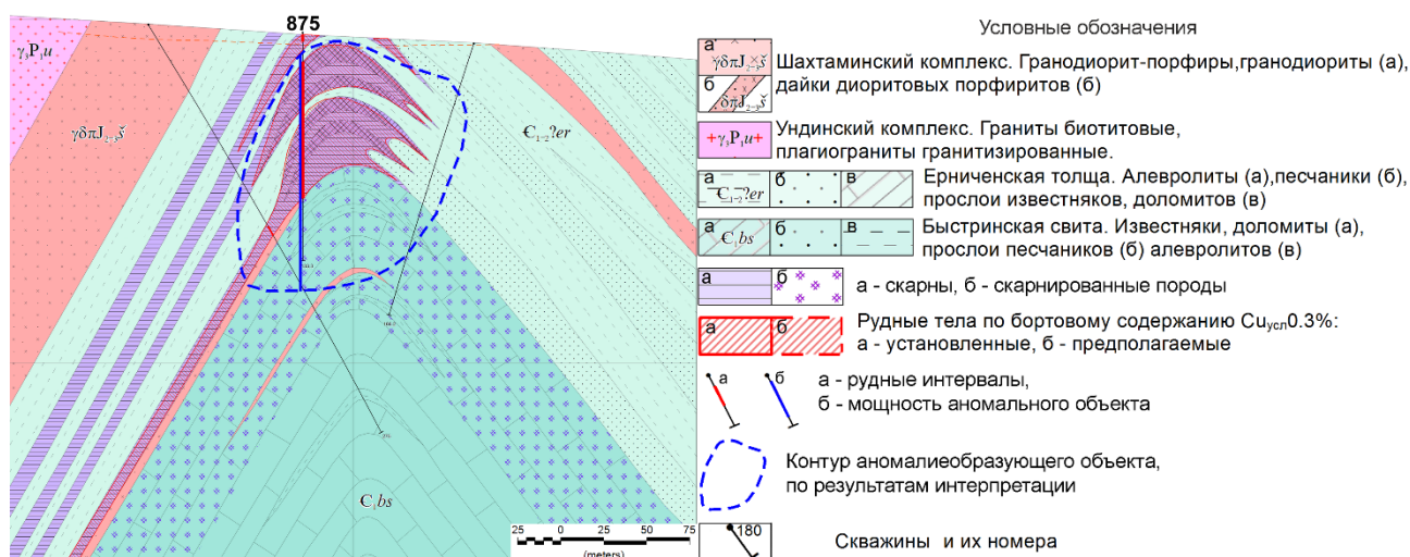
Рис. 9. Расчет коэффициента рудоносности на примере скважины № 875 (геологический разрез по материалам ООО «Востокгеология», 2013). Составил Груздев Р.В., 2015 г.
