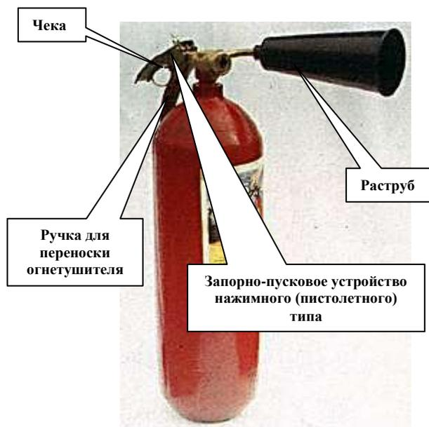
**Выдернуть чеку или сорвать пломбу, направить раструб на очаг пожара, -в запорно-пусковом устройстве нажимного типа нажать на рычаг.**
