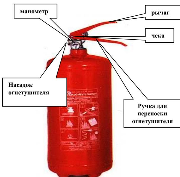
**Сорвать чеку, направить насадок огнетушителя на очаг пожара, резко нажать на рычаг и быстро отпустить. Через 5 секунд повторно нажать на рычаг, направив струю порошка на огонь. Держать огнетушитель строго вертикально, не переворачивать.**
