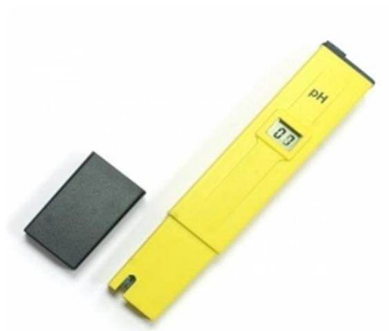
Рисунок 1. Полевой прибор для измерения водородного показателя
