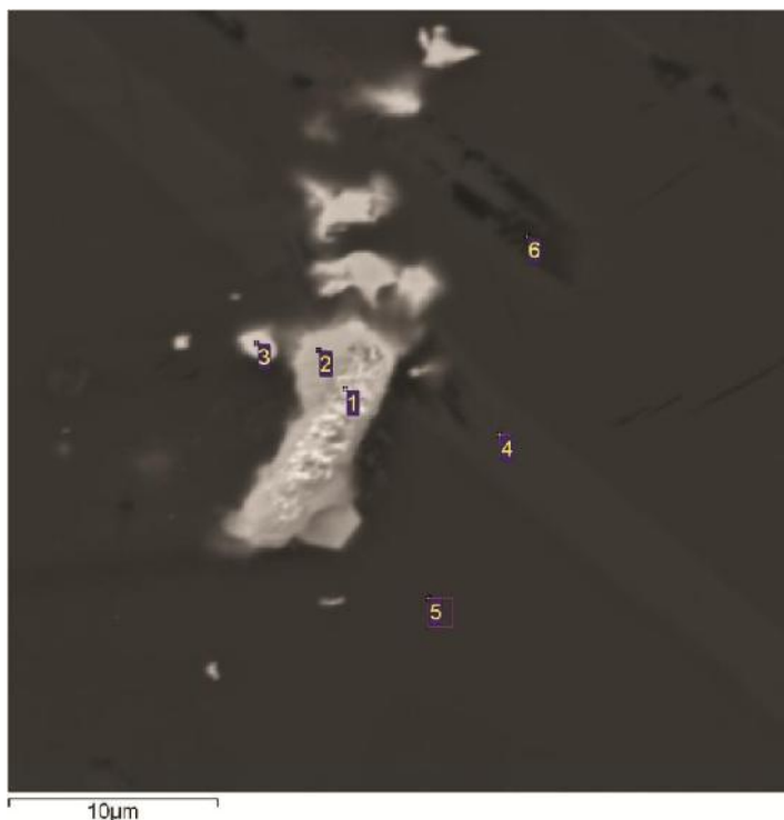
Рисунок 2. Микро- и нановключения платиноидов в нефрите Горлыкгольского месторождения (содержания в %).
