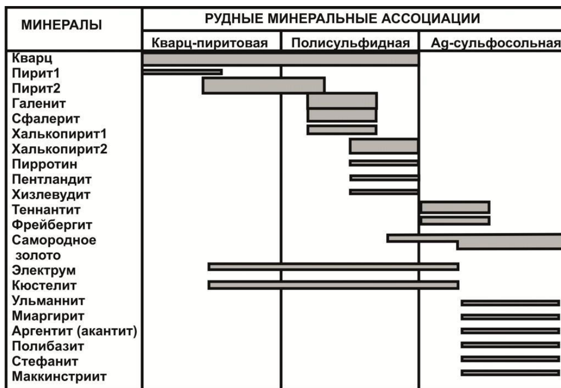
Рисунок 2. Последовательность образования рудных минералов Зун-Оспинского месторождения.
