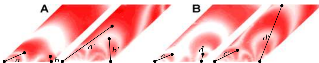
Рисунок 15 - Цифровой анализ нижних частей модельных слэбов (призм) до и после критической нагрузки. А – модельная призма с плотностью 0.998 \text{ г/см}^3 и вязкостью 6.18 \times 10^3 Пуаз. В – модельная призма с плотностью 0.890 \text{ г/см}^3 и вязкостью 11.38 \times 10^3 Пуаз. Чёрные отрезки показывают одни и те же векторы напряжений в модельной призме в спокойном состоянии и при погружении под действием груза, т.е. a трансформируется в a' ( a \rightarrow a' ), b \rightarrow b' , c \rightarrow c' и d \rightarrow d' . Направления векторов сохраняются практически неизменными, что свидетельствует о равномерном распределении нагрузки в процессе эксперимента
