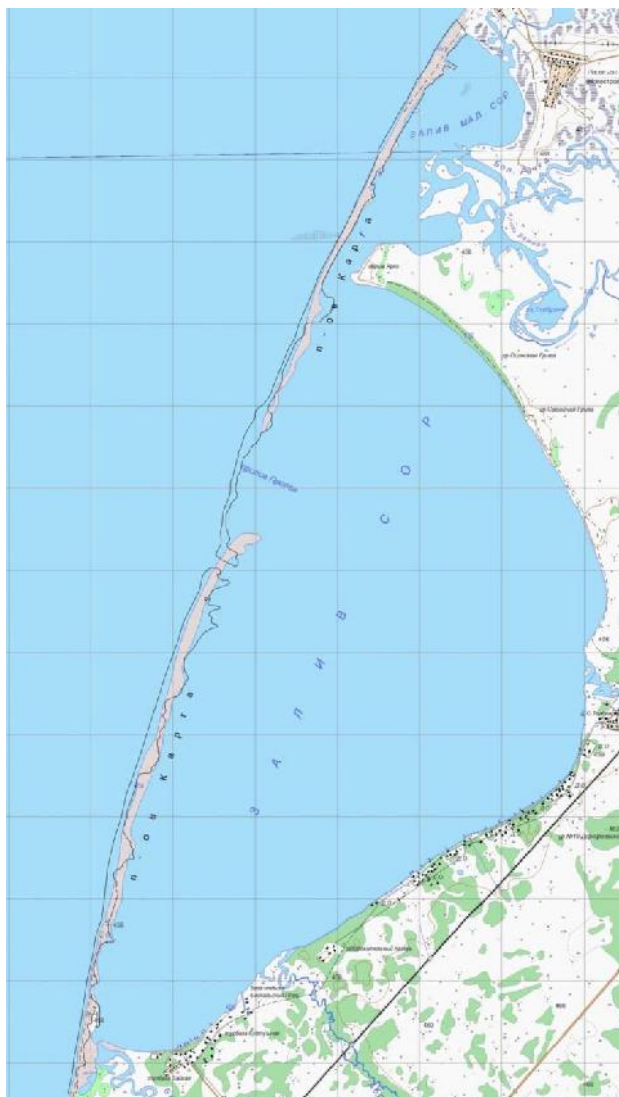
Рисунок 12 - Топографическая карта района залива Сор 1:50000 масштаба, составленная по материалам съемки 2011. Черной ломаной линией путем наложения показан контур полуострова Карга с карты, созданной по материалам геодезической съемки 1942 г
