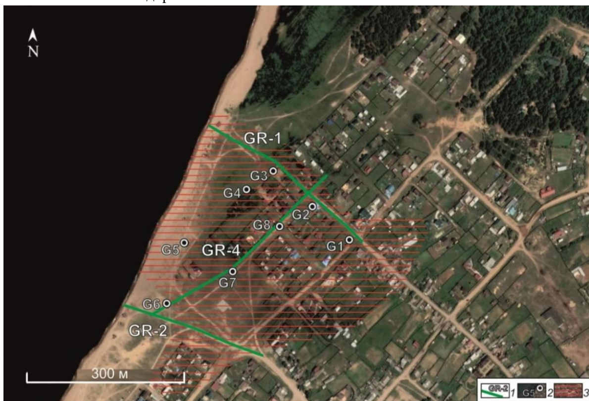
Рисунок 4 – Космоснимок с. Гремячинск. Условные обозначения: 1 - расположение георадарных профилей, 2 - места бурения гидрогеологических скважин, 3 - территория подверженная умеренному подтоплению
