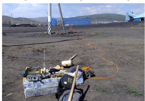
Рис. 8. Пример расстановки для сейсмозондирования.
