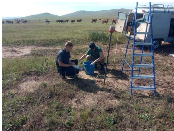
Опробование полевой методикой отбора проб газов из зоны аэрации, оз. Нижнее Белое, Джидинский район Бурятии
