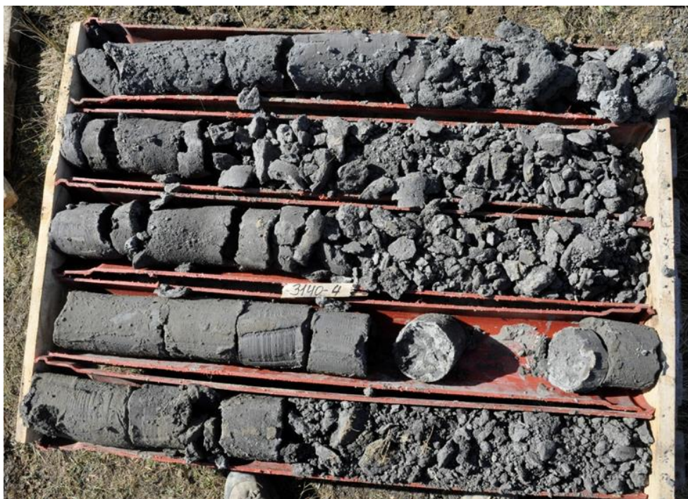
Рисунок 22 – Керновый материал при ведении буровых работ на объекте
