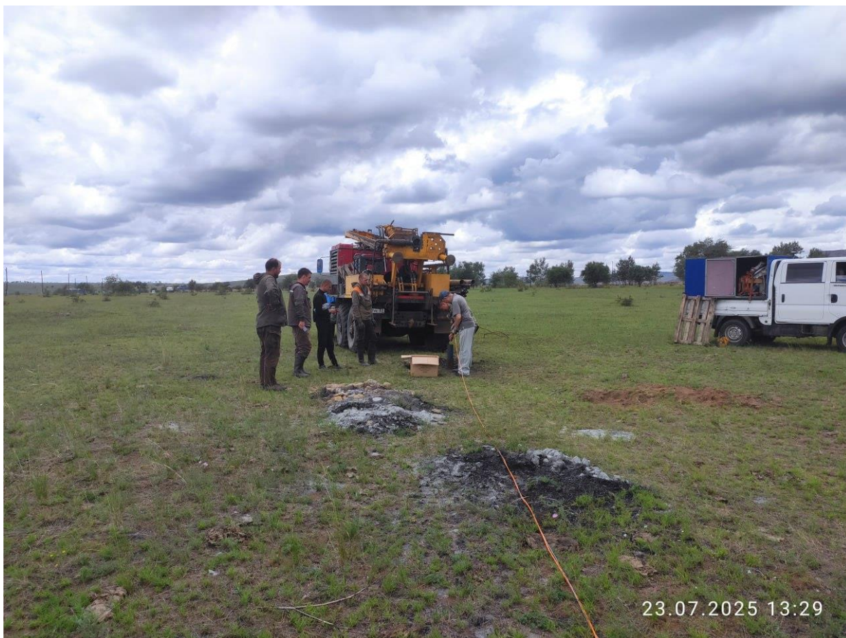
Экспериментальные работы по установке скважинного сейсмического датчика в районе Окино-Ключевского бурогольного месторождения
